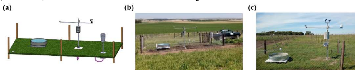
Figura 2. a. Esquema de la estación evaporimétrica desarrollada a partir de la configuración seleccionada, b. Instalación de la estación en el viñedo Finca 74, c. Implementación de una segunda estación en la finca San Eusebio, Tandil, Argentina.
